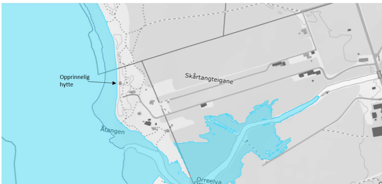
Figur 4.2. Vannstand ved stormflo med 200 års returintervall ved beregnet havnivå i 2090 https://kartverket.no/sehavniva/ ved Åtangen. Plasseringen av den opprinnelige hytten er vist med pil.
